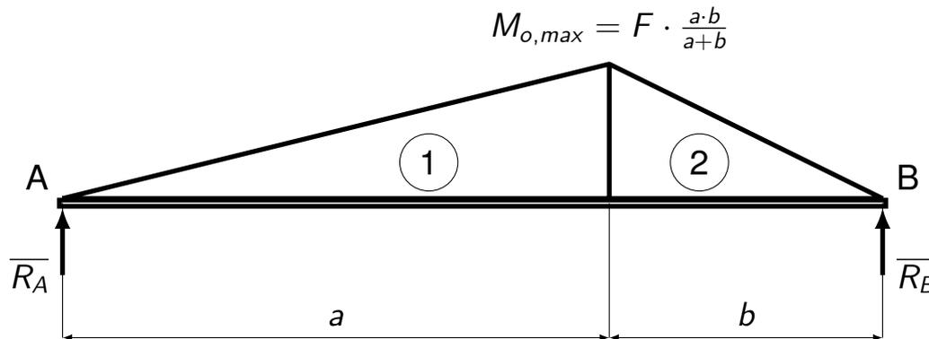
Napište rovnice rovnováhy. Použijte 'RA' pro  $\overline{R_A}$  atd.
