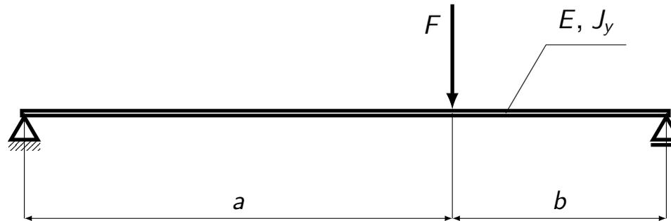
Určete polohu a hodnotu maxima průhybu nosníku. Použijte při řešení Mohrovu metodu náhradního nosníku.
